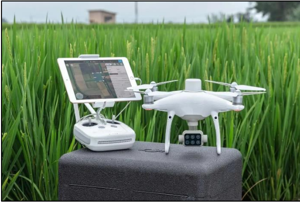
Abbildung 7: DJI P4 Multispectral mit fest verbauten Sensor (Copyright © 2022 DJI).
