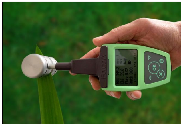
Abbildung 4: Dualex Optical Leafclip Meter zur Bestimmung des Chlorophyllgehaltes in Pflanzen (ITK© 2022).
