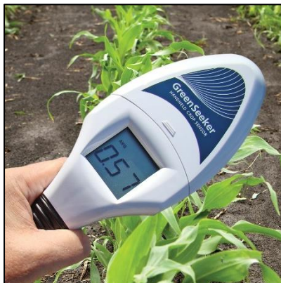
Abbildung 2: Greenseeker Handheld Crop Sensor. Das Display zeigt den aktuellen NDVI der Pflanzen (Trimble Inc. © 2022).
