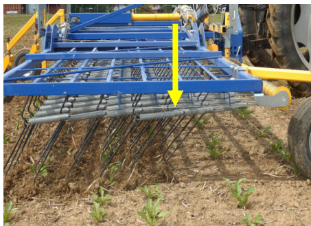
Zinkenstriegel mit indirekter Federung der Zinken
