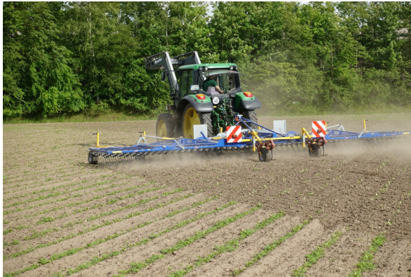
Durch das Striegeln diagonal zur Särichtung lassen sich die Beikräuter gut aus den Rübenreihen striegeln
