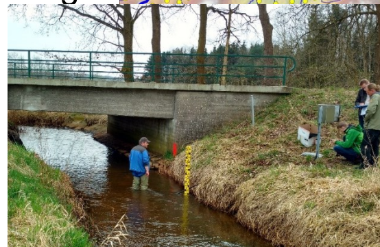
Meßstelle Emern mit Versorgungsstation am Ufer
