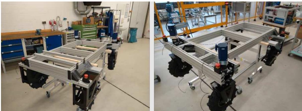
**Abbildung 9:** Finaler Rahmen und Fahrwerk (links: Vorderseite, rechts: Rückseite)
