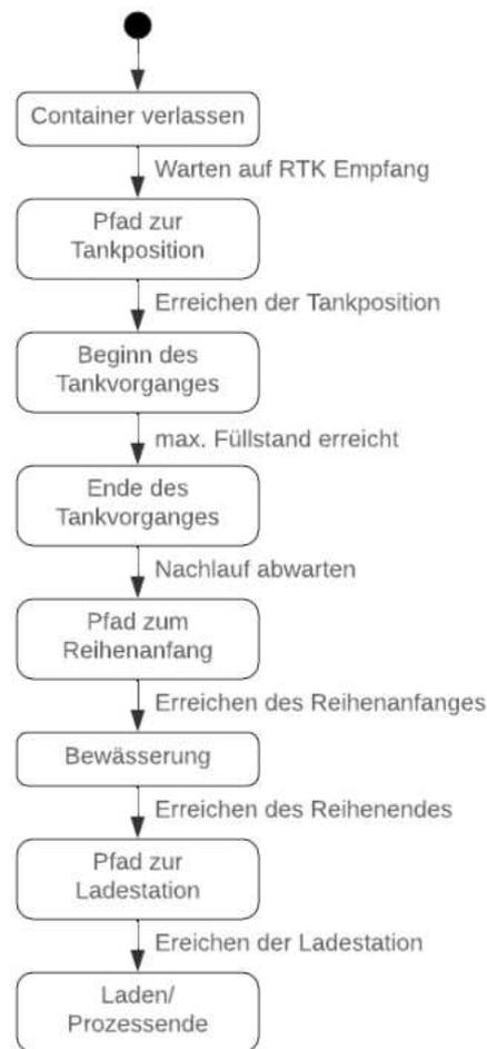
**Abbildung 33:** simpler Ablauf eines Einzelzyklus
