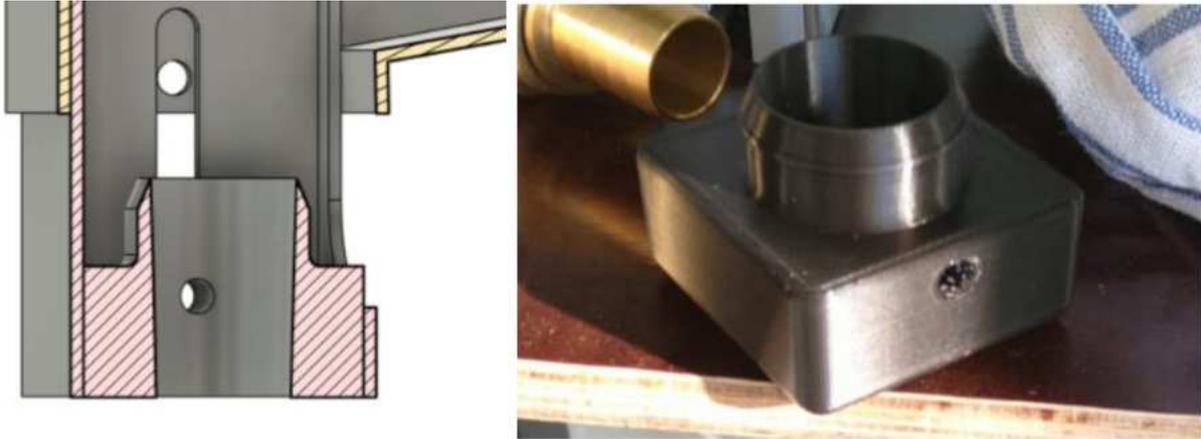
**Abbildung 28:** Betankungsdüse - Schnittansicht (links) - 3D-gedrucktes Bauteil (rechts)
