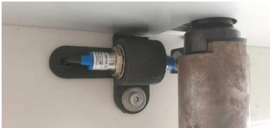
**Abbildung 37:** Türöffnungssensor im montierten Zustand
