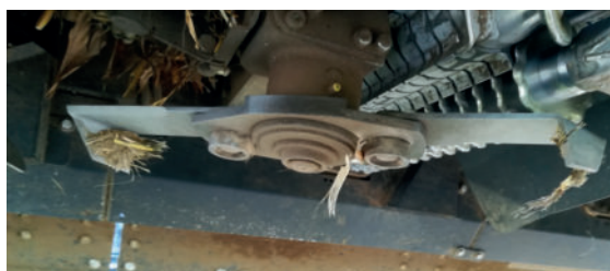
Der Horizon Star* III nutzt spezielle Werkzeuge am Horizont-hächsler, um die Maisstop-peln bodennah zu zerschlagen (Quelle: S. Ramm).
